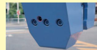
チャッキングプレート固定ボルト部
